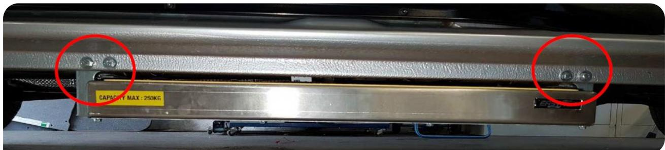
**Bitte beachten Sie gebohrte Löcher für die Befestigungen und den Türkontaktschalter mit geeigneten Rostschutzmitteln wieder zu versiegeln!**
